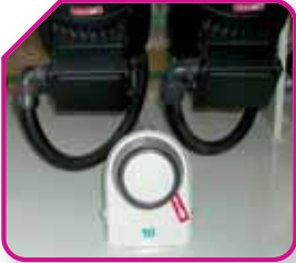
Regolazione frontale filetto posteriore. Front regulation for the rear aris spindle. Vorderverstellung des hinteren Saum. Regulación frontal mandrino arista posterior. Réglage frontal du mandrin arête postérieure.
