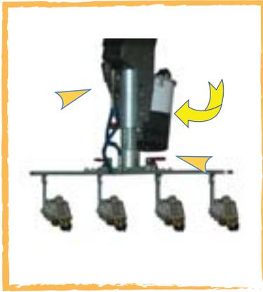
Elektronisch gesteuerter Schwingarm mit 4 Farbpistolen mit gleichmäßigem und genauer Bewegung, damit eine gleichmäßige Besprühung gewährleistet ist.
