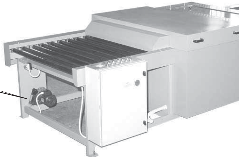
Fig.9 Regolazione velocità rulli traino Fig. 9 Loading/Speed adjustment
