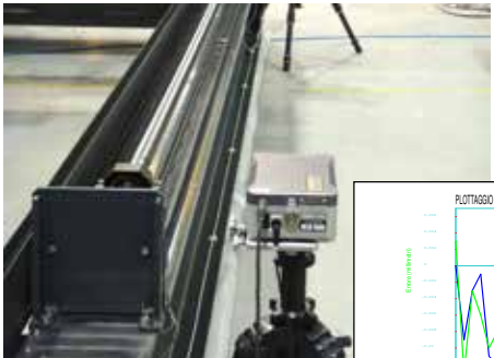
Renishaw Laser Straightness and Linearity control and compensation Controllo e Compensazione di Rettilinearità e Linearità tramite Laser Renishaw
