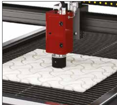
Hydrofinish texturing system Sistema per il trattamento superficiale con tecnologia hydrofinish
