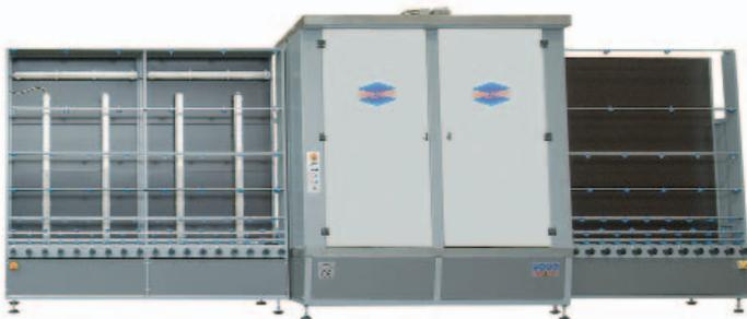
Macchine Lavatrici asciugatrici Verticali modello **1300, 1600, 2000, 2200, 2500, 2600 e 2800** per la lavorazione di medie e grandi lastre di vetro piano e per inserimento in linee di produzione di vetrate isolanti.
