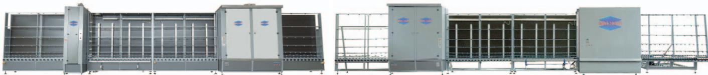
Linea modello 1600, 2000, 2200 e 2500 per la produzione vetro isolante composta da lavatrice verticale con 4 o 6 spazzole cilindriche, risciacquo finale con acqua demineralizzata mediante fila parallela di ugelli spruzzatori e resistenza elettrica per il riscaldamento dell' acqua. Asciugatura tramite 2 soffianti con ventilatore ad alta pressione.
